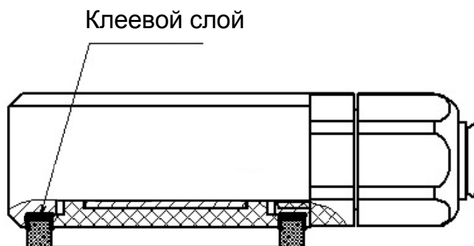
Рис.8.4 – Расположение прокладки на корпусе измерителя
